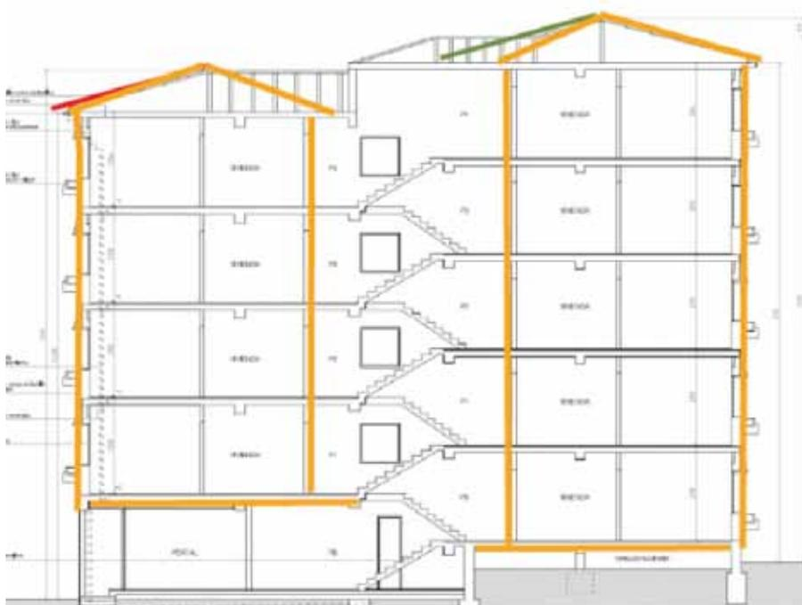
Sección transversal del edificio con las actuaciones envolventes
